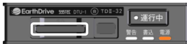
④取り出したSDカードからDTU-1三要素解析ソフトにて運行データを取得して下さい。
